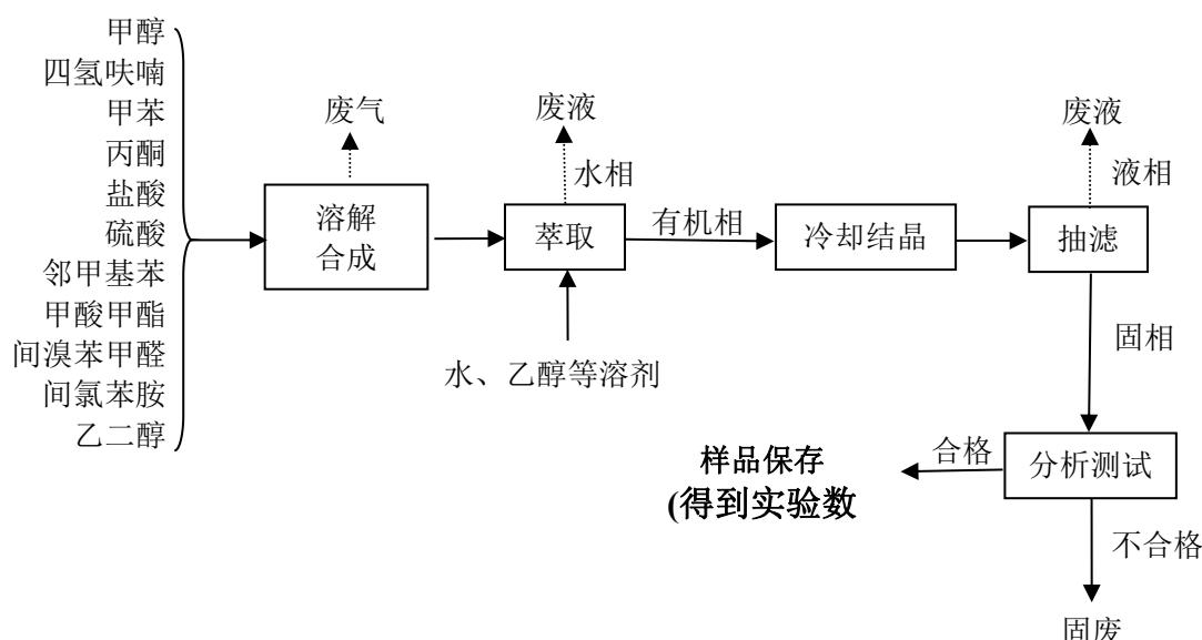
图 2-1 实验流程图
